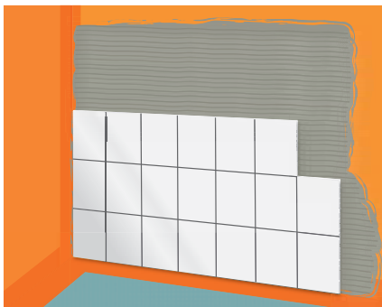
Zdjęcie 6: Układanie glazury na zaprawie cienkowarstwowej z kleju FERMACELL typu Flexkleber na całej powierzchni uszczelnienia (zapewnienie uszczelnienia dla klas zagrożenia wilgocią A)
