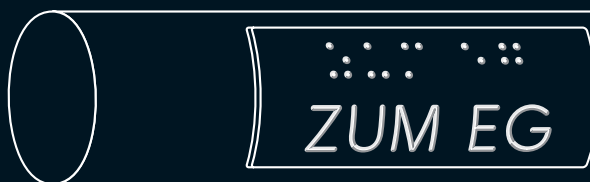
Poręcz z informacjami do odczytania poprzez dotyk Handrail with tactile information
