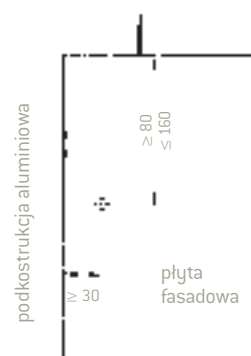
Minimalne odstępy od krawędzi na podkonstrukcji aluminiowej
