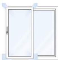
Skrzydło odstawione od ramy o ok. 6 mm.
