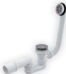
Zalecany do brodzika Sabina z otworem pod syfon i przelewem Ø 52 mm. Odpływ wody sterowany systemem ClickClack (naciśnięcie powoduje zamknięcie odpływu a ponowne naciśnięcie jego otwarcie).
