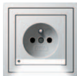
Gniazdo wtyczkowe z bolcem ochronnym, podświetleniem orientacyjnym LED i ochroną dla dzieci
